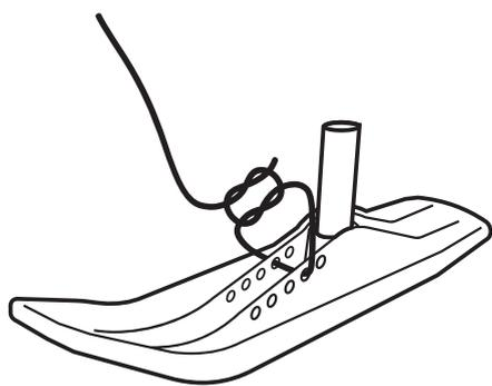
рис. 2 Крепление буксировочной веревки
