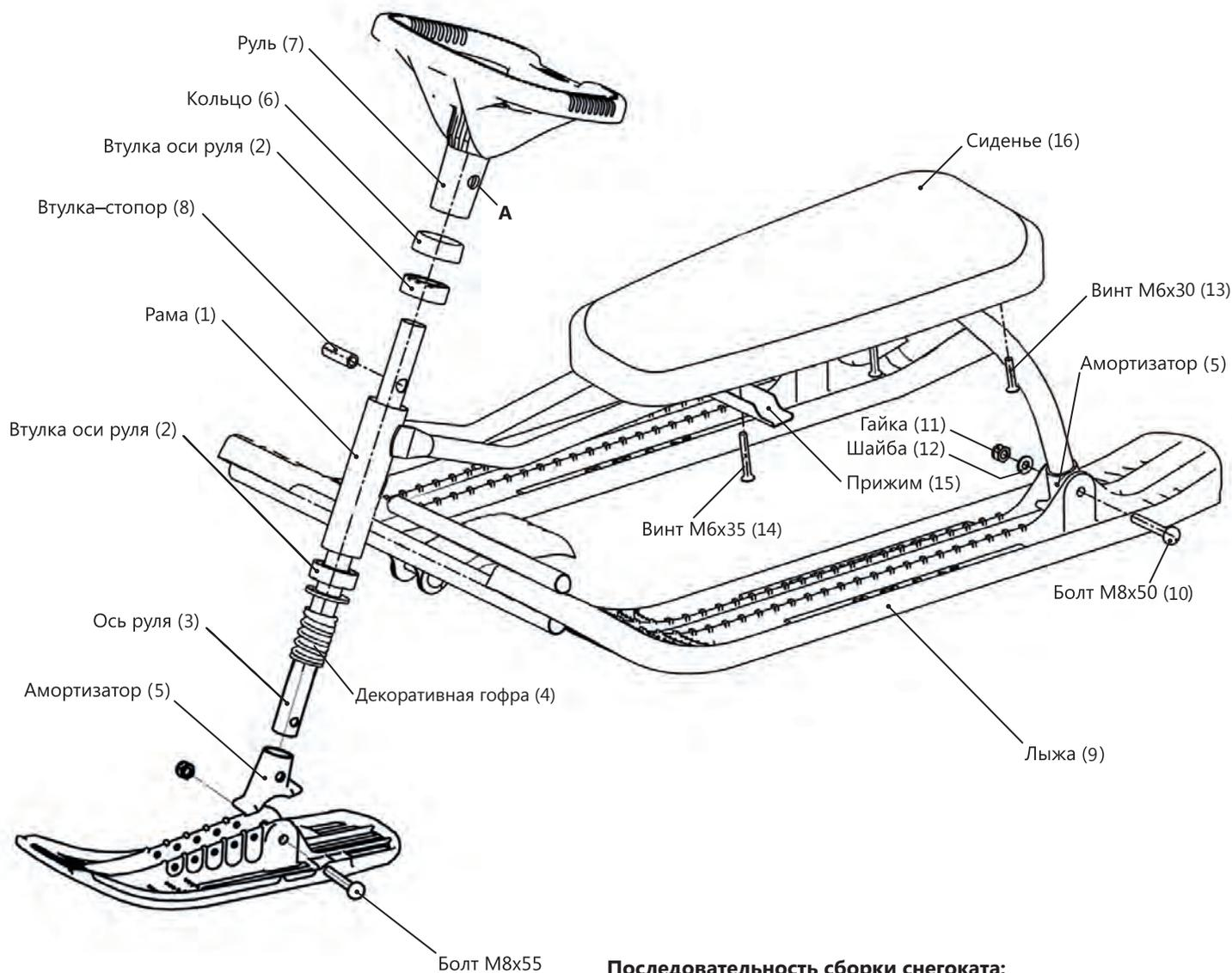
рис. 1 Сборка снегоката арт. ТСЛ
